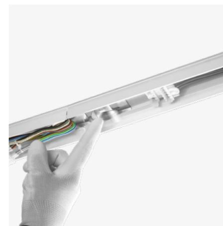
Die Verbindung beider Profile selbst wird durch Einrasten des Verbindungsmechanismus hergestellt. Es erfordert keine Kraft, keine Werkzeuge und dauert eine Sekunde. Dann sind die Trägerprofile nur noch mit Strom zu versorgen und die Lichtmodule einzustecken.
